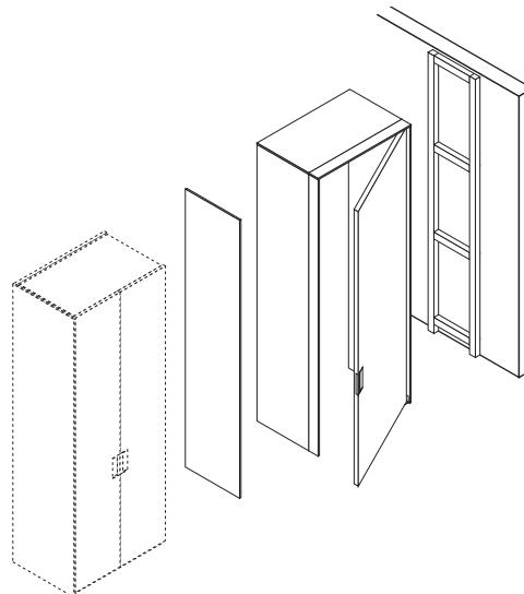
Per l'accostamento del portale alla parete è necessario utilizzare un telaio a parete predisposto per fissare lo stipite. Telaio con regolazione telescopica, spessore da 35 a 55.
