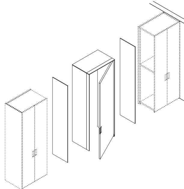
Per l'accostamento del portale all'armadio è necessario utilizzare un fianco interno spessore 15, predisposto per fissare lo stipite, al posto del fianco laterale di serie.
