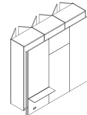
I pannelli boiserie devono essere finiti ai lati con sagome di finitura per boiserie retro armadio, larghezza mm 14. La boiserie retro armadio, ad altezza unica o sovrapposta, può essere attrezzata (escluso specchio) con una sola mensola Code per pannello, con e senza luce a led (p 280-300, spessore 8), con il modulo di cablaggio per una presa elettrica o due prese usb o con gli specchi Drop, Circle e Audrey.
